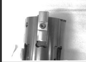
⑩ 2番ガイド先端部の工具調整時用ボルト穴はネジ長が短いので注意して下さい。
