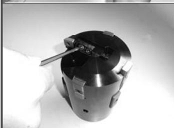
④. 切刃カートリッジのクランプネジを一度緩め、再度仮締めして下さい。
