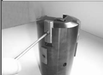
②. 製品購入時に付属のマスターガイドを 工具調整時用ボルト穴 にセットします。
